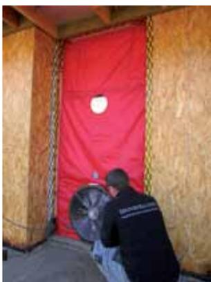
ENSAYO BLOWER DOOR EN UNA VIVIENDA PASSIVHAUS CON ESTRUCTURA DE MADERA.
