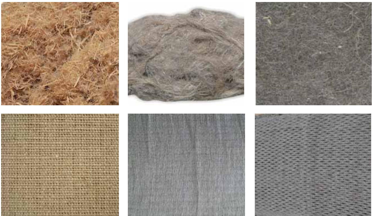
Figura 2. Materiales útiles para el refuerzo de biocomposites: fibra de madera (arriba izquierda); fibra de lino corta (arriba centro); mat de lino punzonado (arriba derecha); tejido tafetán de yute (abajo izquierda); tejido de lino unidireccional (abajo centro); tejido de lino tridimensional (abajo derecha).
