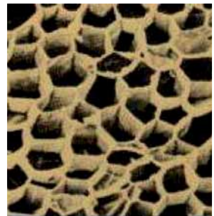
Figura 7. Estructura celular del corcho.
