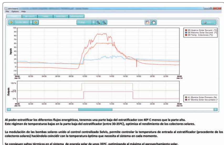
Comportamiento sistema energía solar: \Delta T , y potencia (kW).
